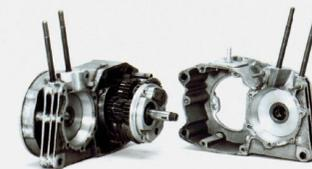
Der geöffnete Motor der 50er MZ mit Achtganggetriebe 1962. (Foto Gräger)
